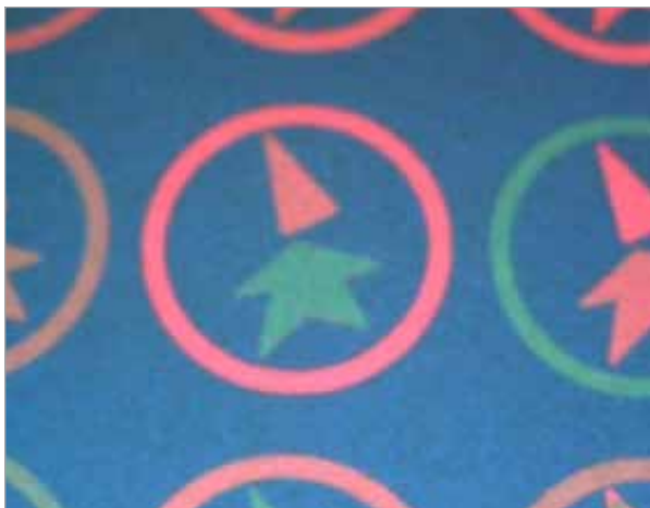
Ein unsichtbares Logo aus CANdot Serie X Nanopartikeln fluoresziert unter UV-Bestrahlung.
