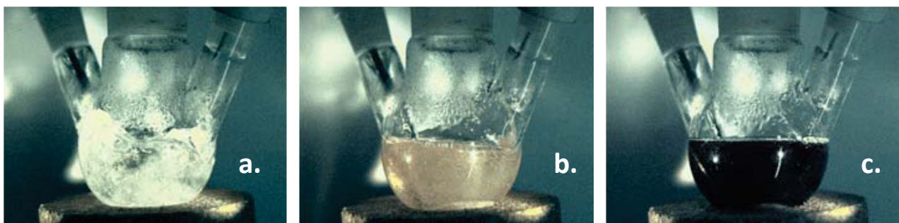
Abbildung 1: Synthese von PbS-Nanopartikeln während der Injektion (a.), 100 ms nach der Injektion (b.) sowie 500 ms nach der Injektion (c.).
